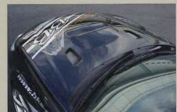
ボンネット自体はノーマルだが、純正を加工することで、インタークーラーのサイドに二箇所エアバレッジを設けている。
