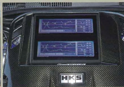
インタークーラーのあった位置にはミラーモニターが2枚セットされる。ただしこれはあくまでデモンストレーション用だ。ちなみにインタークーラーは前向き化されている。
