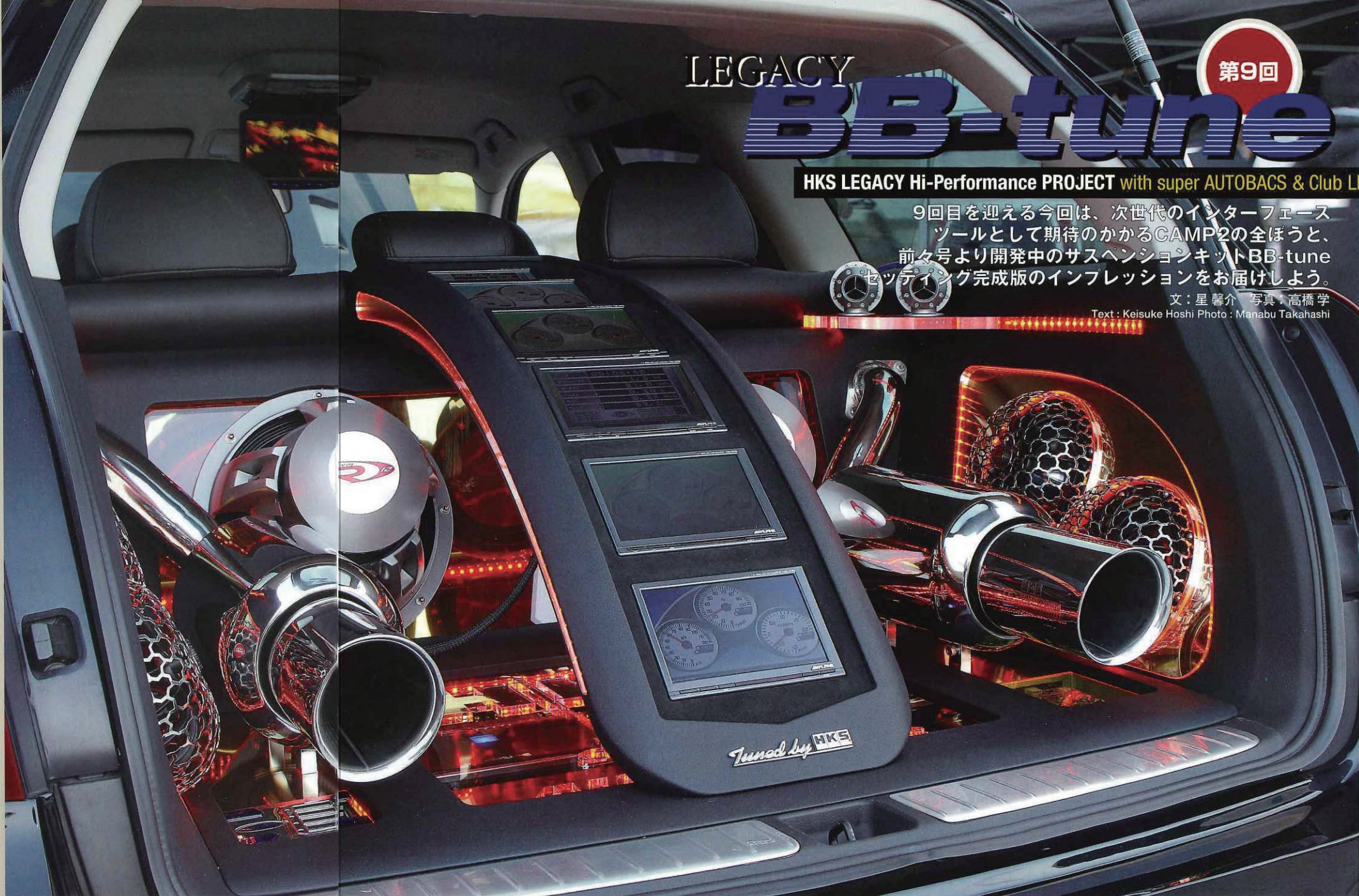
インタークーラーのあった位置にはミラーモニターが2枚セットされる。ただしこれはあくまでデモンストレーション用だ。ちなみにインタークーラーは前向き化されている。
