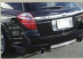
リアバンパーはHKSのマフラー形状をより引き立たせ、フィットする形に変わっているが、マフラーの逃げのために設けられた「返し」などは同様の意匠だ。
