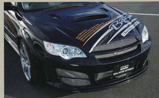
バンパーは基本的にはモノクラフトコンセプトRを踏襲するが、インタークーラー用に開口部を大型化したり、LEDを埋め込んだりとほぼワンオフの品だ。
